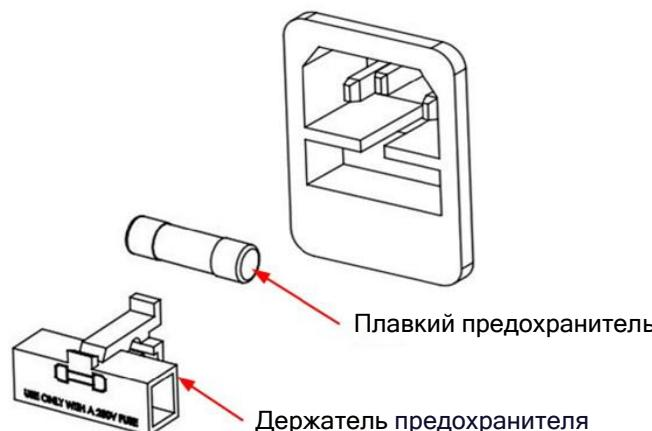
Рисунок 9.1 Замена плавкого предохранителя.
